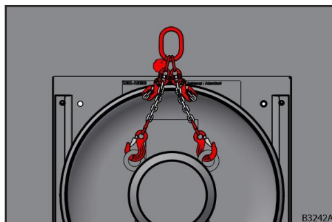
Abb. 26: Einhängen der Anschlagketten bei zwei Anschlagösen
